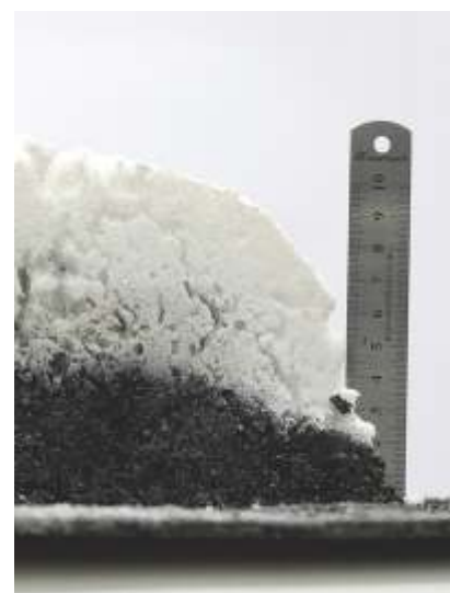
防火涂层PLAMCOR的隔热层，在高温的影响下膨胀
