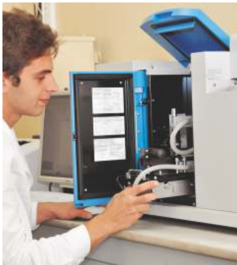
在激光分析仪上研究金属粉末的分散
